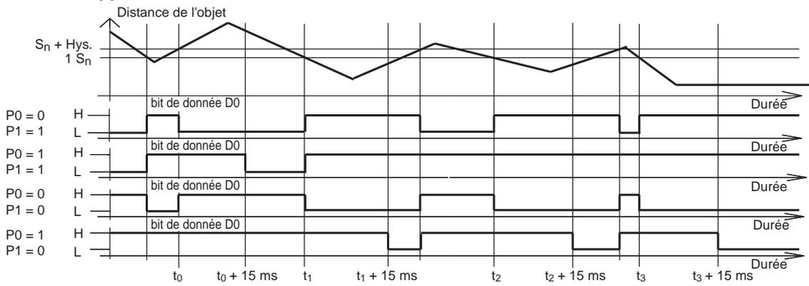
Le retard à l'appel/retard à la retombée s'enclenche présélectionnée (P0=1). Retard à l'appel de 15 ms, lorsque P0=1 et fonction à fermeture (P1=1). Retard à la retombée de 15 ms, lorsque P0=1 et fonction à ouverture (P1=0).
