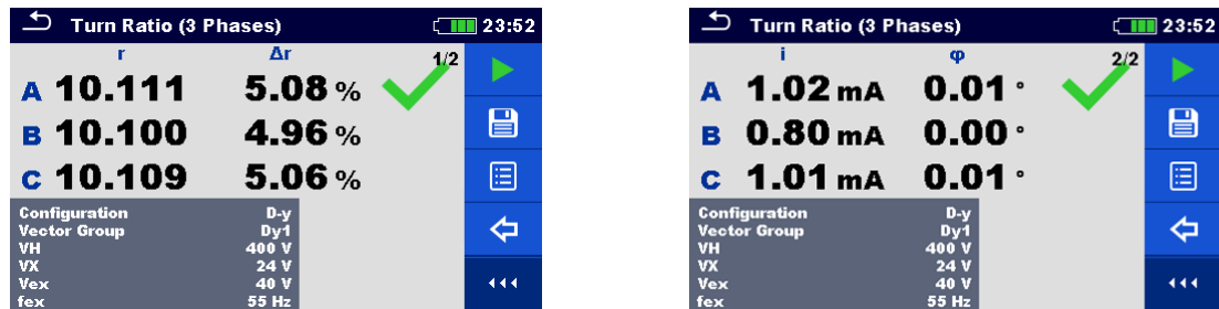
Figure 11.14: Résultats du transformateur triphasé : rapport de transformation (gauche), courant d'excitation et déphasage (droite) : limite ( \Delta r ) = 10 %
