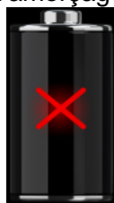
Image 2.5: Indication d'un défaut de la batterie (charge suspendue, défaut de la minuterie, batterie absente)
