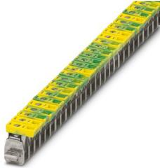
Bloc de jonction, tension nominale: 300 V, intensité nominale: 76 A, type de raccordement: Raccordement vissé, Section de référence: 16 mm<sup>2</sup>, section : 1,5 mm<sup>2</sup> - 16 mm<sup>2</sup>, montage: Barre collectrice de N, coloris: vert/jaune
