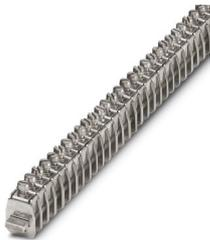
Bloc de jonction, type de raccordement: Raccordement vissé, Section de référence: 16 mm<sup>2</sup>, section : 1,5 mm<sup>2</sup> - 16 mm<sup>2</sup>, montage: Barre collectrice de N, coloris: argenté
