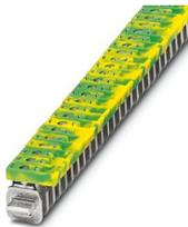
Bloc de jonction, tension nominale: 300 V, intensité nominale: 41 A, type de raccordement: Raccordement vissé, Section de référence: 4 mm<sup>2</sup>, section : 0,5 mm<sup>2</sup> - 6 mm<sup>2</sup>, montage: Barre collectrice de N, coloris: vert/jaune
