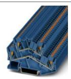
Bloc de jonction à deux étages, Mode de raccordement: Raccordement Push-in, Section : 0,14 mm² - 4 mm², AWG: 26 - 12, Largeur: 5,2 mm, Coloris: bleu, Type de montage: NS 35/7,5, NS 35/15
