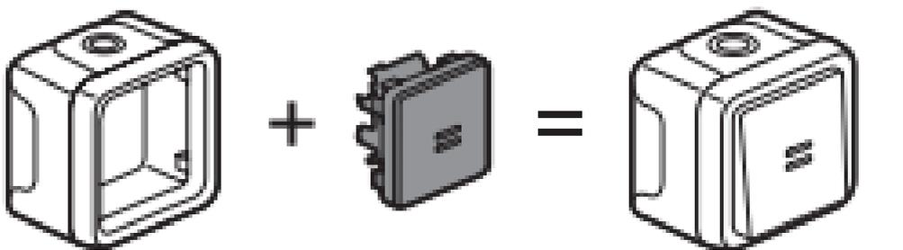
Pour commander un circuit lumière (télérupteur) jusqu'à 5 endroits différents
