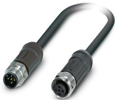
Câble préconfectionné pour bus, CANopen<sup>®</sup>, DeviceNet<sup>™</sup>, 5-pôles exempt d'halogène, blindé, connecteur mâle droit M12, détrompage: A, sur Connecteur femelle droit M12, détrompage: A, longueur de câble: 4 m, pour applications extérieures, avec molette inox
