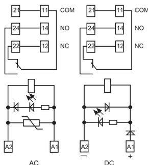
\* Avec courants >10 A, les bornes des contacts doivent être raccordées en parallèle (21 avec 11, 24 avec 14, 22 avec 12).
