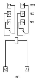
**Interfaces modulaires à relais****1 inverseur - Largeur 15.8 mm****Idéal pour l'interfaçage des sorties d'automate****Type 48.P3**
