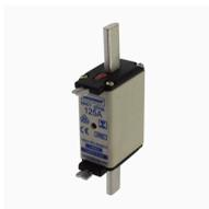
**Cartouche fusible, Basse tension, 125 A, AC 400 V, 120 kA, NH01, gL/gG, IEC, à double indicateur de fusion, pattes d'extraction isolées**
