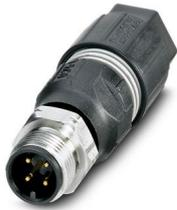
Connecteur, Universel, 4-pôles, connecteur mâle droit M12, détrompage: A, Raccordement autodénudant, matériau de la molette: Acier inoxydable 1.4404, diamètre extérieur du câble 4 mm ... 8 mm
