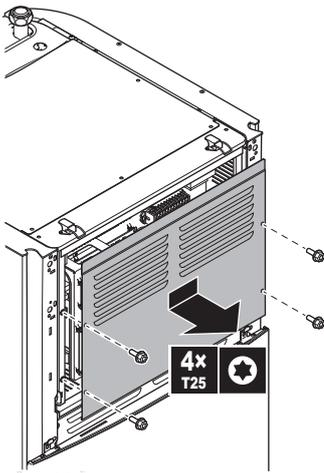
4 Si nécessaire, retirez la plaque frontale. Cela s'avère par exemple nécessaire dans les cas suivants:
