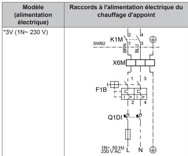
F1B Fusible de surintensité (à fournir). Fusible recommandé: 2 pôles; 16 A; courbe 400 V; classe de déclenchement C.
