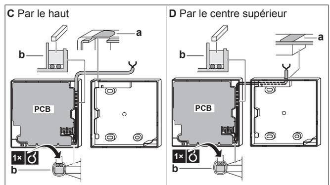
a Faites une encoche pour que le câblage passe par les pinces, etc.
