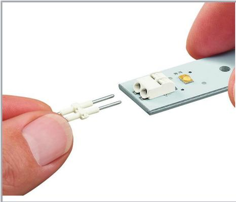
Enficher l'élément de raccordement dans la borne.
