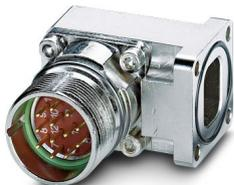
Embases paroi avant, coudé rigide, Verrouillage à vis, M23, nombre de pôles: 12, type de contact: Mâle, Joint torique axial, 4x Ø 3,2, indice de protection: IP67, nombre de pôles: 12, type de raccordement: Raccordement à sertir, série: RF, L'article est sans plomb, conformément à la directive RoHS II, sans exception 6c (Pb < 0,1 %)
