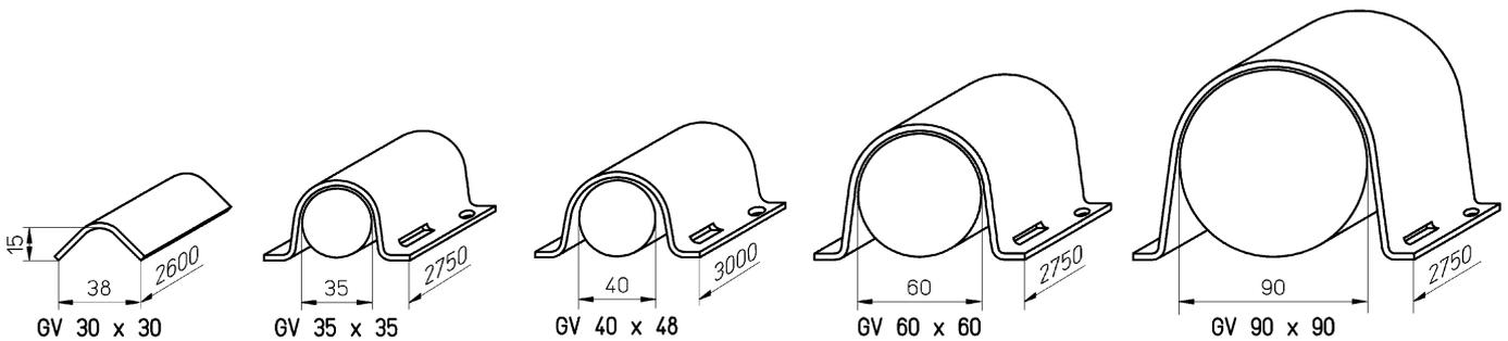
La gaine de protection PLIOLINE des remontées de câbles aéro-souterraines (BT et MT) se fixe sur les poteaux béton ou bois avec du feuillard inox ou des vis grâce aux fentes et trous aménagés à cet effet. Seul, le profilé pour câble de terre ne comporte ni trou ni fente et se fixe au moyen d'une bande.
