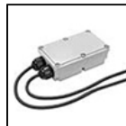
S.2496 DALI RELAY SWITCH pour ON-OFF (NON GRADABLES) 230V APPAREILS Tous les appareils fonctionnant à 230V non gradables (ON-OFF) peuvent être contrôlés ON-OFF avec le système DALI avec les accsoires interfaces suivants. Il s'en suit que l'appareil sera contrôlé à distance dans le seul mode ON-OFF et non pas en mode gradable. IP67 Max nominal load 1000VA Max switching current 8A Max inrush current 80A Dimensions 175,5mm x 86,5mm x 43mm
