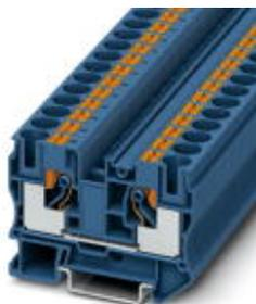
Blocs de jonction simple, Mode de raccordement: Raccordement Push-in, Nombre de connexions: 2, Section :0,5 mm<sup>2</sup> - 16 mm<sup>2</sup>, AWG: 20 - 6, Largeur: 10,2 mm, Hauteur: 49,5 mm, Coloris: bleu, Type de montage: NS 35/7,5, NS 35/15
