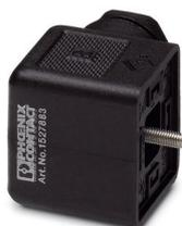
Connecteur pour électrovannes, Universel, 4-pôles, Connecteur de vanne A, Raccordement vissé, presse-étoupe Pg9, diamètre extérieur du câble 6 mm ... 8 mm
