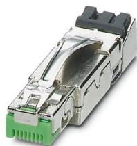
Connecteur RJ45, type: RJ45, indice de protection: IP20, nombre de pôles: 8, 1 Gbit/s, CAT5, matériau: Métal, type de raccordement: Raccordement autodénudant, section raccordable: AWG 23- 22, sortie du câble: droit, coloris: vert, Ethernet / PROFINET
