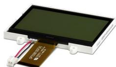
Module LCD graphique 2,8", 128 x 64 pixels, FSTN transflectif/positif 6:00, rétroéclairage à LED, interface : 8 bits, température de fonctionnement : -20 °C .. 70 °C
