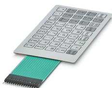
Clavier à membrane adhésif, technologie des pistes conductrices en argent, 45 touches, estampé, 4 couleurs, câble de raccordement : 77 mm, avec connecteur femelle à sertir, pas 2,54 mm, température de fonctionnement : - 20 °C ... 70 °C
