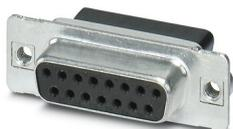
Porte-contacts D-SUB , taille Shell 2, pour 15 contacts de signalisation, type de contact femelle, pour contacts à sertir, droit, fixation au moyen d'un filetage M3, pour cadre de montage VS-15-...
