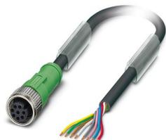
Câble pour capteurs/actionneurs, 8-pôles, PUR exempt d'halogène, gris-noir RAL 7021, extrémité libre, sur Connecteur femelle droit M12, détrompage: A, longueur de câble: 5 m
