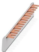
Pont de câblage pour modules avec pas de raccordement 17,5 mm, monophasé, 8 pôles, section transversale 35 mm<sup>2</sup> et embouts montés
