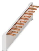
Pont de câblage pour modules avec pas de raccordement 17,5 mm, monophasé, 6 pôles, section transversale 35 mm<sup>2</sup> et embouts montés
