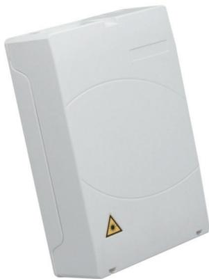
Le PBO est un boîtier de distribution d'intérieur pour les réseaux FTTH qui permet le raccordement jusqu'à 12 abonnés. Il s'utilise aussi bien pour du piquage tendu que conventionnel. C'est le point d'interface entre le câble de la colonne montante et le câble d'abonné.
