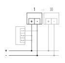
Alimentation sur pile 9 V. Option possible : mise en réseau de 30 détecteurs max. / relais PROTECTOR K (max. 300 m de câblage)
