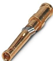
Contact à sertir, diamètre de contact: 1,6 mm, tournés, Connecteur femelle, matériau de contact: Alliage de cuivre, surface des contacts: doré, section raccordable: 1 mm<sup>2</sup> ... 1 mm<sup>2</sup>, AWG 18
