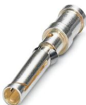
Contact à sertir, diamètre de contact: 1,6 mm, tournés, Connecteur femelle, matériau de contact: Alliage de cuivre, sans plomb, surface des contacts: plaqué argent, section raccordable: 0,14 mm<sup>2</sup> ... 0,34 mm<sup>2</sup>, AWG 24 .. . 22
