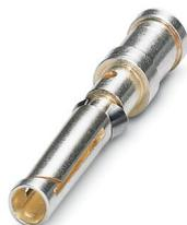
Contact à sertir, diamètre de contact: 1,6 mm, tournés, Connecteur femelle, matériau de contact: Alliage de cuivre, sans plomb, surface des contacts: plaqué argent, section raccordable: 1 mm<sup>2</sup> ... 1 mm<sup>2</sup>, AWG 18
