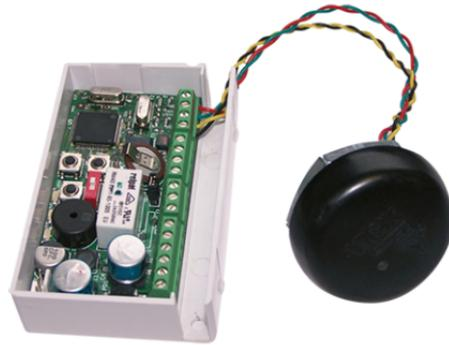
Centrale de contrôle d'accès, gestion Autonome/des claviers SKRV - utilise les badges de proximité réf: CLE (10 couleurs) - A compléter avec clavier SKRV - Boîtier PVC dimensions : 87x 55 x 20 mm
