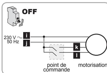
1) Rétablir l'alimentation. Vérifier le sens de rotation de la motorisation à l'aide du point de commande filaire :
