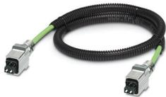
Câble en fibre optique prééquipé, câble PROFINET type B, fibre PCF 200/230 µm, boîtier métallique Push-Pull SC-RJ/IP67 des deux côtés, gaine extérieure en PVC, exempt d'halogène, résistant à l'ozone et aux UV, dans une gaine de protection, pour pose fixe en intérieur, longueur : 10 m
