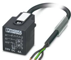
Câble pour capteurs/actionneurs, 3-pôles, extrémité libre, sur Connecteur de vanne A, avec 1 LED, câblé avec Varistance 230 V, longueur de câble: 5 m
