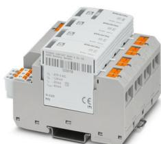
Parafoudre composé d'un élément de base avec technologie de raccordement Push-in, contact de télésignalisation Push-in et fiches de protection, pour le montage sur NS 35/7,5. Tension nominale : 230 V AC, circuit 3+1
