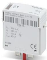
Fiche parafoudre de type 2 avec varistance haute performance pour élément de base VAL-MS-PT, surveillance thermique, signalisation optique de défaut.
