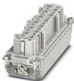
Éléments de contact, Taille: B24, Nombre de pôles: 24+PE, Connecteur femelle, Raccordement Push-in, 500 V, 16 A, 0,14 mm<sup>2</sup> ... 2,5 mm<sup>2</sup>, Application: Puissance
