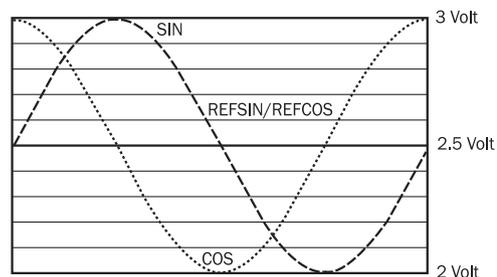
Évolution du signal pour une rotation de l'axe dans le sens horaire, vue dans la direction « A » (voir plan côté) 1 période = 360 ° : 1.024
