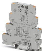
Module de sortie analogique pour modules logiques PLC logic (2e génération uniquement), à 1 canal, type de signal (4 mA ... 20 mA, 0 mA ... 20 mA, 0 V ... 10 V, 2 V ... 10 V), configurable via DIP switchs, raccordement Push-in
