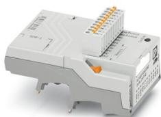
Module de base PLC logic, 2e génération, avec 16 E/S, enfichable sur huit blocs de jonction PLC-INTERFACE TOR ou analogiques, extension possible à 48 E/S, horloge en temps réel, connecteur femelle micro USB, logement pour module de mémoire et adaptateur Bluetooth, raccordement Push-in
