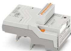
Module de base PLC logic avec raccordement RS-485 pour communication Modbus/RTU, avec 16 E/S, enfichable sur 8 blocs de jonction TOR ou analogiques PLC-INTERFACE, extension possible à 48 E/S, horloge en temps réel, connecteur femelle micro USB, logement pour module de mémoire et adaptateur Bluetooth, raccordement Push-in
