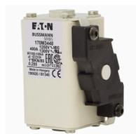
**Cartouche fusible, grande vitesse, 400 A, AC 1250 V, 100 kA, compact size 1, 45 x 59 x 81 mm, aR, IEC, UL, indicateur de type K**
