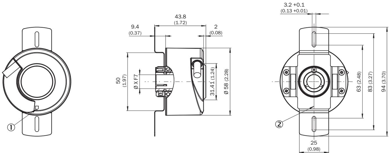
Valeurs XF7, voir le tableau des diamètres d'axe pour le type axe creux non traversant
