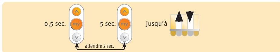
Augmenter ou diminuer la force de la détection en appuyant sur « montée » ou « descente ». Puis confirmer.
