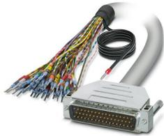
Câble rond blindé préconfectionné; raccordement 1 : Fils individuels (50-pôles) (Les fils sont repérés et équipés d'embouts. La tresse de blindage sort d'une extrémité de câble distincte.); raccordement 2 : Connecteur mâle D-SUB (1x 50-pôles); longueur de câble: variable
