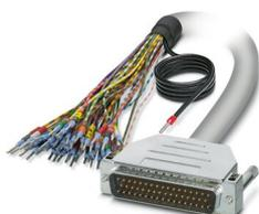
Câble rond blindé préconfectionné; raccordement 1 : Fils individuels (50-pôles) (Les fils sont repérés et équipés d'embouts. La tresse de blindage sort d'une extrémité de câble distincte.); raccordement 2 : Connecteur mâle D-SUB (1x 50-pôles); longueur de câble: 3 m
