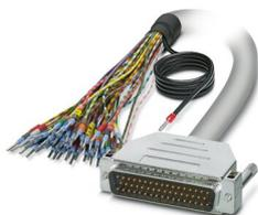
Câble rond blindé préconfectionné; raccordement 1 : Fils individuels (50-pôles) (Les fils sont repérés et équipés d'embouts. La tresse de blindage sort d'une extrémité de câble distincte.); raccordement 2 : Connecteur mâle D-SUB (1x 50-pôles); longueur de câble: 6 m
