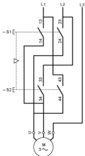
En combinaison avec bloc d'isolement tripolaire XACS399 ou XACS3991, représenté en position inactive (en attente de mise sous tension de la station), équipé d'un opérateur d'arrêt d'urgence à action de déclenchement de verrouillage par clé.
