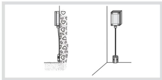
**Nota:** per facilitare la manutenzione, la sonda è mobile, si consiglia di pulirla periodicamente per evitare l'accumulo di polvere tra la sonda ed il pavimento.
