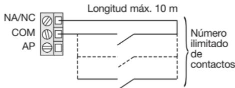
**ATENCIÓN:** la conexión de un bucle de auto protección es automática si la conexión se realiza antes de conectar la alimentación.
