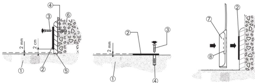
Pour une sonde posée verticalement, le trou de fixation de la plaque métallique doit être en haut.
