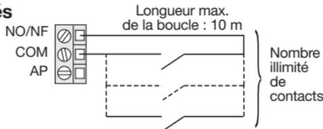
**ATTENTION :** le raccordement d'une boucle autoprotégée doit être effectué avant le branchement de la pile. La reconnaissance de cette dernière se fait alors automatiquement lors du branchement de la pile.
