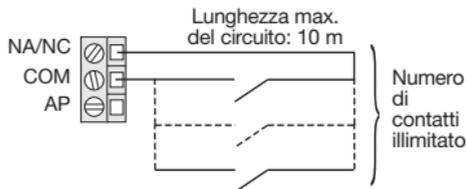
**ATTENZIONE:** Il collegamento di un circuito di autoprotezione deve essere effettuato prima del collegamento della batteria. Il riconoscimento della presenza di tale circuito avviene infatti al momento del collegamento della batteria.
