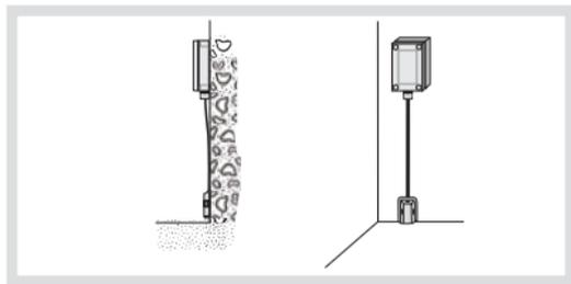
**Nota:** para facilitar el mantenimiento, la sonda es móvil. Es aconsejable limpiarla periódicamente para evitar la acumulación de polvo entre la sonda y el suelo.
