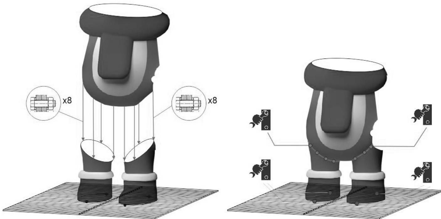
**4** Monter les bras sur la construction à l'aide de 10 boulons M6 comme indiqué ci-dessous
