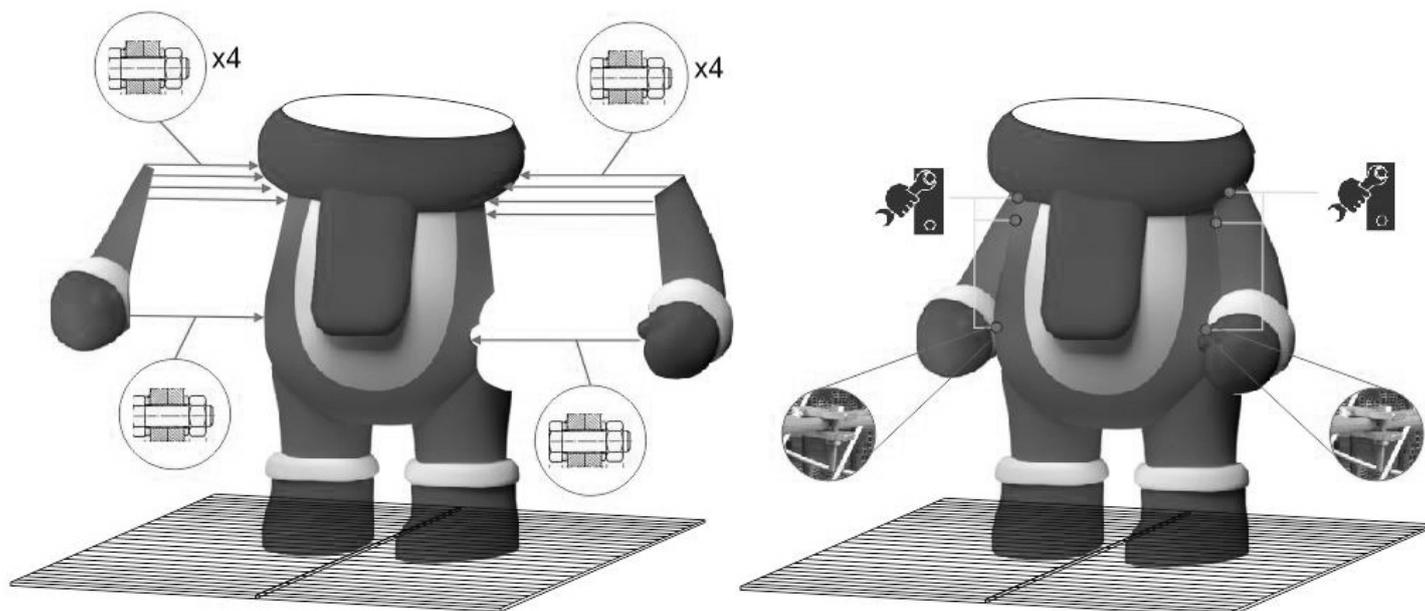
**5** Monter la tête sur la construction à l'aide de 10 boulons M6 comme indiqué ci-dessous
