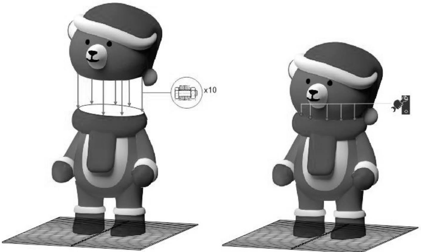
**6** Vérifiez la tension électrique de l'éclairage (24V / 230V). Effectuez les connexions électriques en connectant les fiches Easy-Connect marquées des chiffres correspondants selon le schéma ci-dessous. S'il y a plus d'une paire de fiches, elles sont marquées de couleurs et doivent être montées conformément au marquage.
