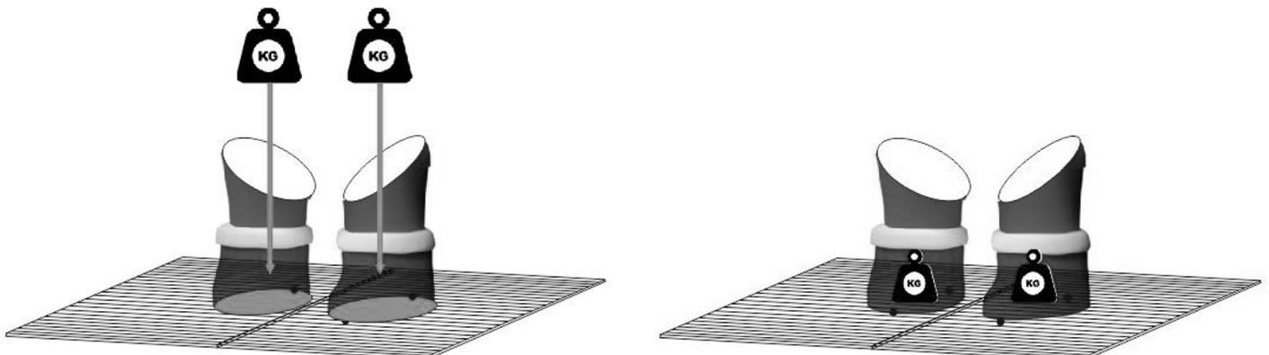
**3** Mettre le corps sur les pieds montés à la grille et les visser à l'aide de 16 boulons M6.
