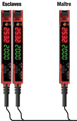
Toutes les entrées multifonction multi funct (broche 2/bc-WH) sont connectées en parallèle
