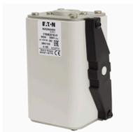
**Cartouche fusible, grande vitesse, 800 A, DC 900 V, size 3, 74 x 90 x 131 mm, gR, IEC, indicateur de fusion simple**
