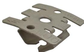
Le QCN combine les propriétés uniques de l'acier ressort et de la technologie «-push-to-install-» (pousser pour installer) CADDY pour créer un écrou de profil de montage à enclenchement facile, avec une installation incroyablement rapide de tige filetée ou de boulons. À utiliser avec un écrou hexagonal sur tige filetée pour l'installation de trapèzes préfabriqués ou avec des boulons à tête ronde pour la fixation murale de boîtiers électriques et autres accessoires.
