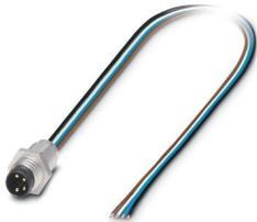
Embases paroi avant, 4-pôles, Connecteur mâle, droit, M8, Montage sur face avant, M8 x 0,5, Cordons individuels, longueur de câble: 0,5 m, 0,25 mm<sup>2</sup>, Cordon PVC
