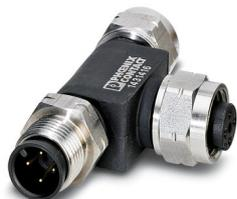
Répartiteur en T pour système bus, 5-pôles, non blindé, connecteur mâle droit M12, détrompage: A, sur Connecteur femelle droit M12, détrompage: A, Broches 2+4 pontées et Connecteur femelle droit M12, détrompage: A, Broches 2+4 pontées, Protection spéciale
