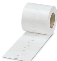
Etiquette, Rouleau, blanc, vierge, repérable avec : THERMOMARK E.300 (D)/600 (D), THERMOMARK ROLL 2.0, THERMOMARK ROLL, THERMOMARK ROLL X1, THERMOMARK ROLLMASTER 300/600, THERMOMARK X1.2, type de montage: insérer, plage de diamètre de câble: 10 ... 25 mm, surface utile: 29 x 8 mm, Nombre d'étiquettes: 5400
