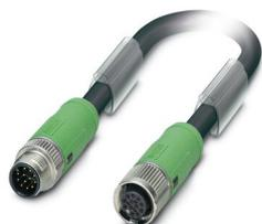
Câble pour capteurs/actionneurs, 12-pôles, blindé, connecteur mâle droit M12, détrompage: A SPEEDCONNEC, câblé avec déconnecté, sur Connecteur femelle droit M12, détrompage: A SPEEDCONNEC, longueur de câble: 0,5 m
