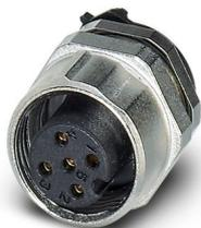
Connecteur d'appareil face arrière, 5-pôles, connecteur femelle, droit, M12-SPEEDCONNEC, détrompage: B, Montage face arrière, M12 x 1, Raccordement soudé THR, Produit de remplacement selon RoHS II sans exception 6c (Pb < 0,1 %) référence : 1239954
