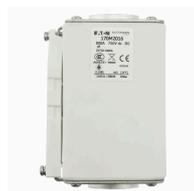
**Cartouche fusible, grande vitesse, 50 A, DC 750 V, 80 kA, compact size 1, 41 x 59 x 128 mm, aR, IEC, indicateur de type K**
