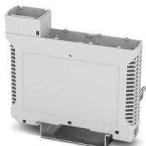
Boîtier électronique sur rail DIN, Partie inférieure du boîtier avec pied métallique de verrouillage, pour connecteurs de bus 50/40, largeur: 39,7 mm, hauteur: 180,1 mm, profondeur: 137,7 mm, coloris: gris clair (7035), connexion transversale: Connecteur de bus sur rail DIN (en option), nombre de pôles connecteur transversal: 50
