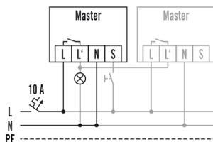
*Installation standard avec commande en option par bouton-poussoir de fermeture et raccordement en parallèle de 8 appareils au maximum*
